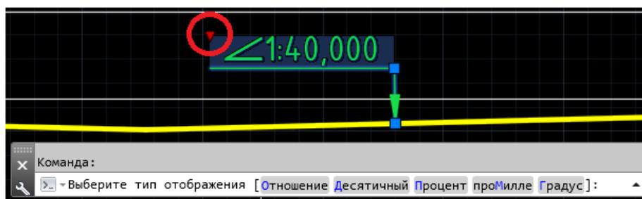
Рис. 115 Выбор типа отображения уклона
