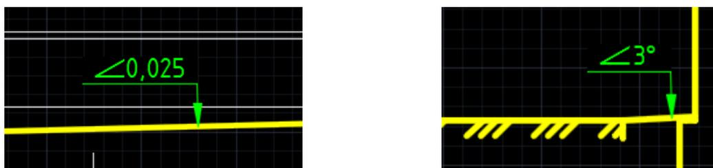
Рис. 116 Обозначение уклонов
