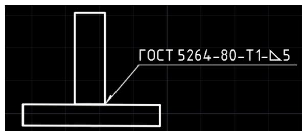
Рис. 27 Команда «Обозначение сварного соединения»
