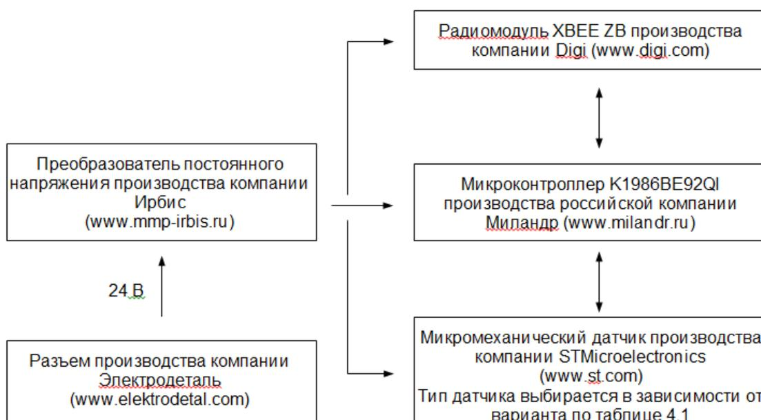
Рисунок – Структурная схема измерительного модуля
