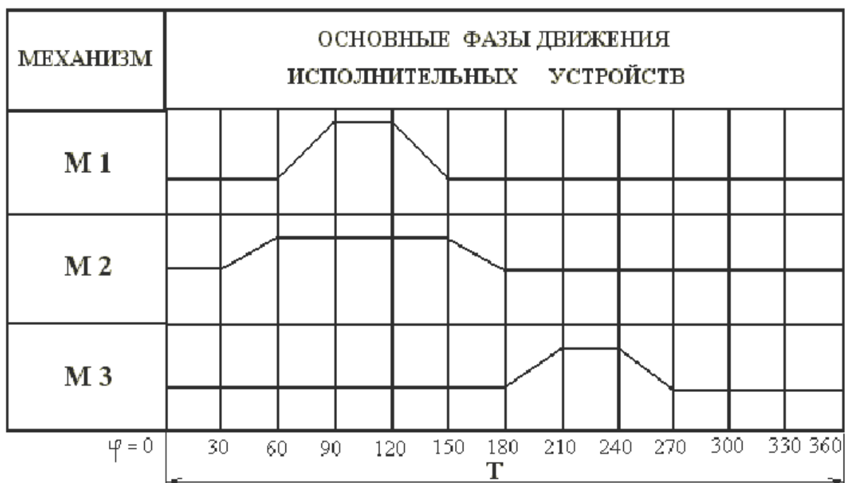
Рис. 3.4.7. Циклограмма автомата для сверления отверстий
