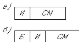
Рис. 5. Содержимое адресного поля команды при индексной (а) и двойной индексной (б) адресации
