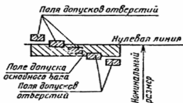
Рис. 20. Образование посадок в системе вала
