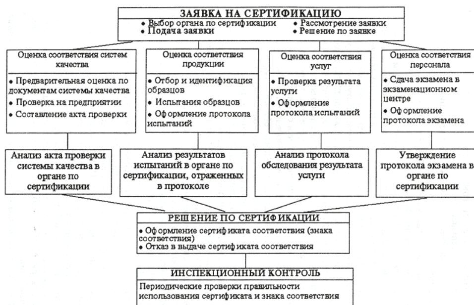
Рис. 12. Обобщенная схема процесса сертификации
