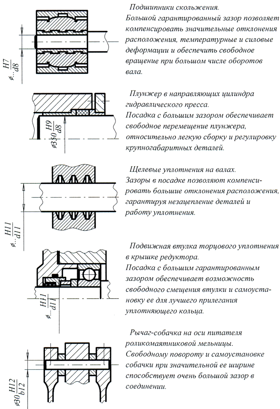
Рисунок 19 — Примеры применения посадок с зазором
