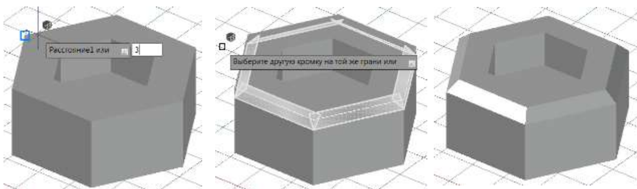
Рис. 179. Пример выполнения команды Фаска по кромке
