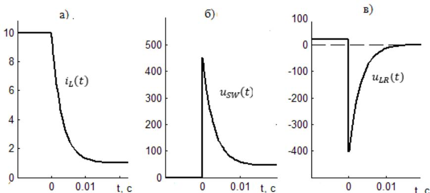
Рис.2.4. Ток цепи - а), напряжение на контактах выключателя - б) и напряжение на катушке индуктивности - в)
