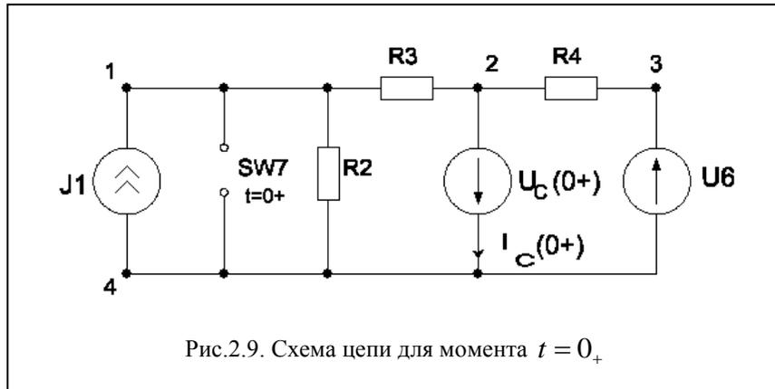
Рис.2.9. Схема цепи для момента  $t = 0_+$
