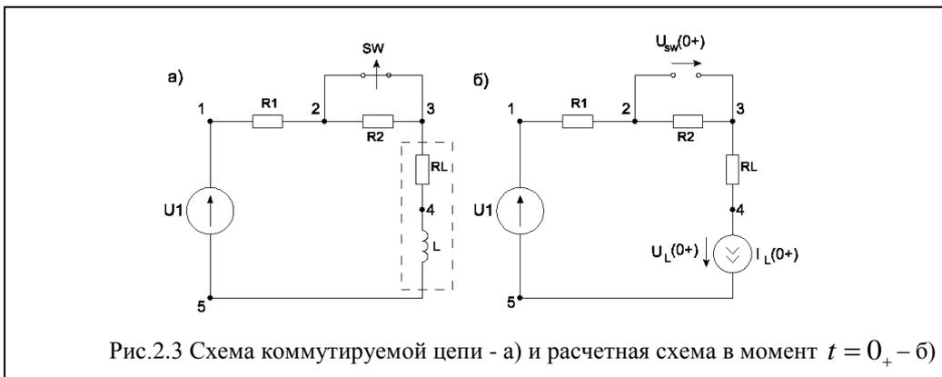
Рис.2.3 Схема коммутируемой цепи - а) и расчетная схема в момент  $t = 0_+$  - б)
