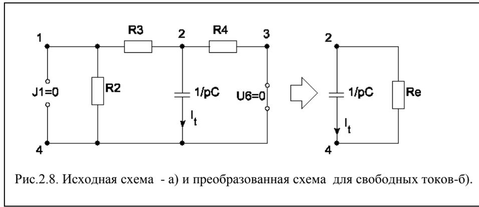
Рис.2.8. Исходная схема - а) и преобразованная схема для свободных токов-б).
