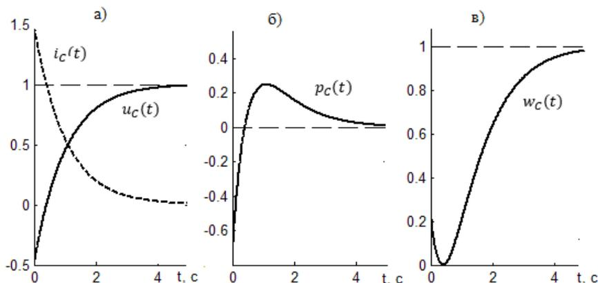
Рис.2.1 Осциллограммы напряжения и тока емкости – а), мощности – б) и запасаемой энергии – в) при начальном значении напряжения  $\hat{u}_0 = -0.5$
