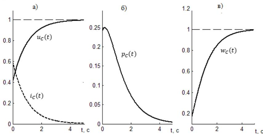
Рис.2.2 Осциллограммы напряжения и тока – а) мощности – б) и запасаемой энергии – в) при начальном значении напряжения емкости  $\hat{u}_0 = 0.4$ .
