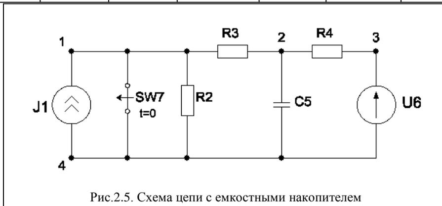
Рис.2.5. Схема цепи с емкостным накопителем
