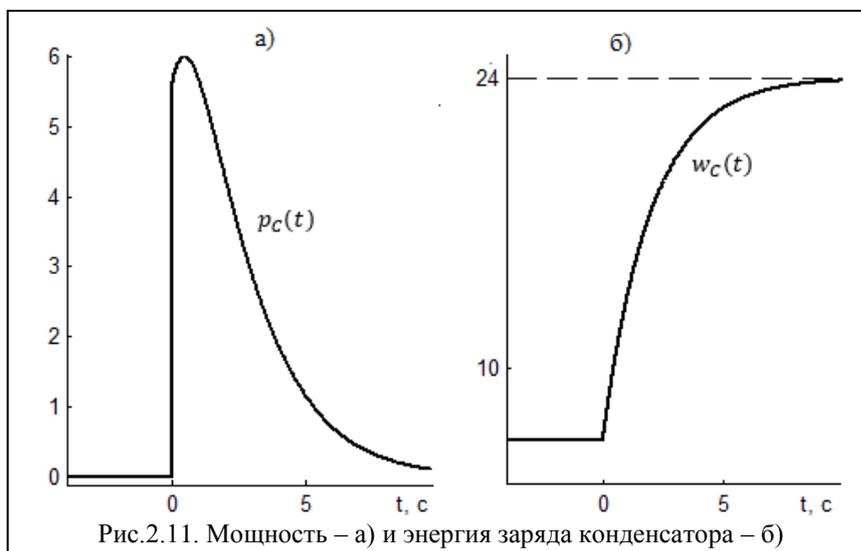
Зависимость  $p_C(t)$  имеет экстремум, координаты которого совпадают со значениями, определенными по формулам (2.5)
