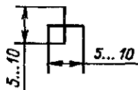
Рис. 8.1. Изображения швов сварных соединений: а — видимых; б — невидимых; в, г — одиночной сварной точки
