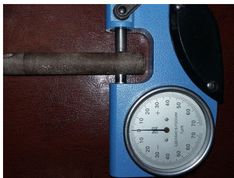
Рис. 7. Задание положения реперной точки отсчета «0»
