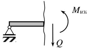
Рассматривая оставленную правую часть балки (левая отброшена), с учётом правила знаков, направляем  $Q^I$  и  $M_{изг}^I$  следующим образом:
