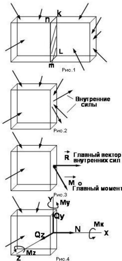
Заменяем всю совокупность внутренних сил в сечении главным вектором  $R_o$  и главным моментом  $M_o$  путем приведения их к центру тяжести сечения согласно основной теореме статики. Для определения  $R_o$  и  $M_o$  нужно составить условия равновесия, поэтому в проекциях на оси координат получим шесть условий равновесия. Для этого разложим  $R_o$  и  $M_o$  на составляющие:
