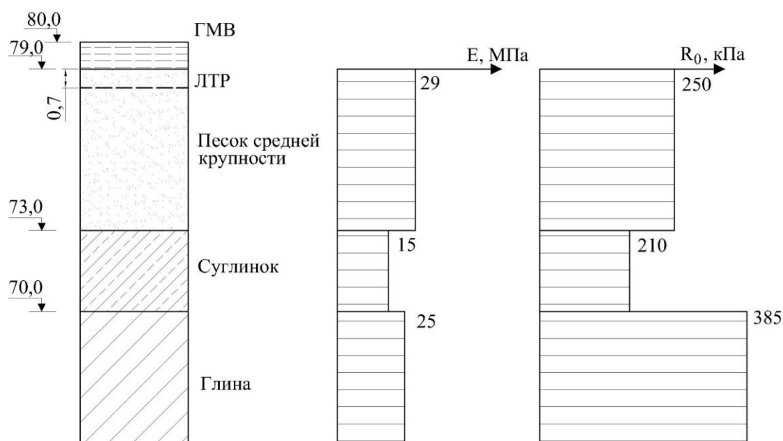
Рис. 2. Эпюры модуля деформации и условного сопротивления грунта
