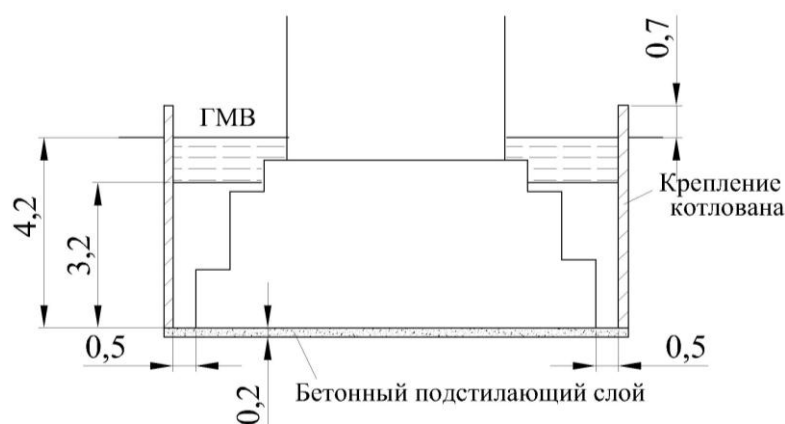
Рис. 13. Схема фундамента с креплением котлована
