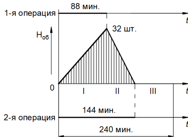
Рисунок 9.9 – Графики работы на двух смежных операциях ОППЛ и эпюра оборотного задела между ними: T_{сдв} = 0
