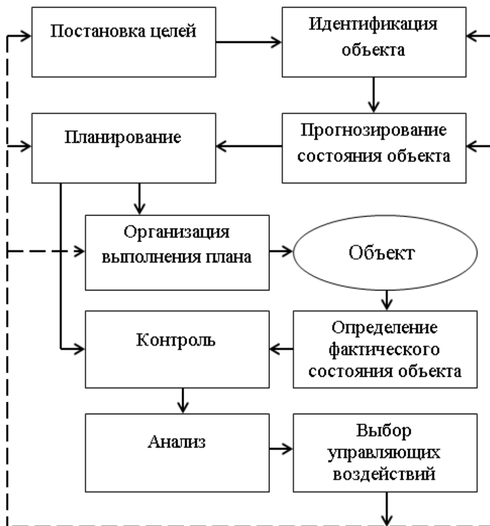
Рис.2. Взаимосвязь функций управления в системе с обратной связью
