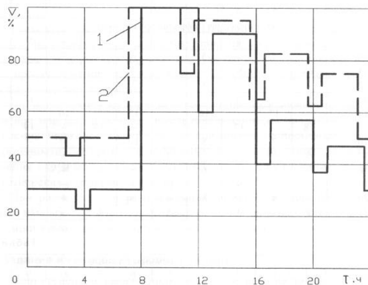
Рис. 1 Суточный график безразмерного расхода сжатого воздуха
