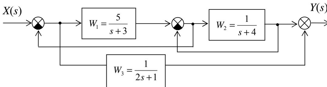
Рис. 3. Пример многоконтурной системы с заданными параметрами
