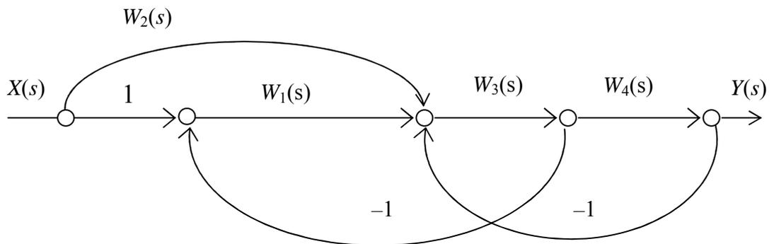
Рис. 2. Сигнальный граф многоконтурной системы
