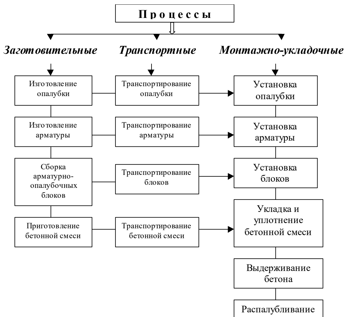
Рис. 2. Схема технологических процессов производства монолитных железобетонных конструкций
