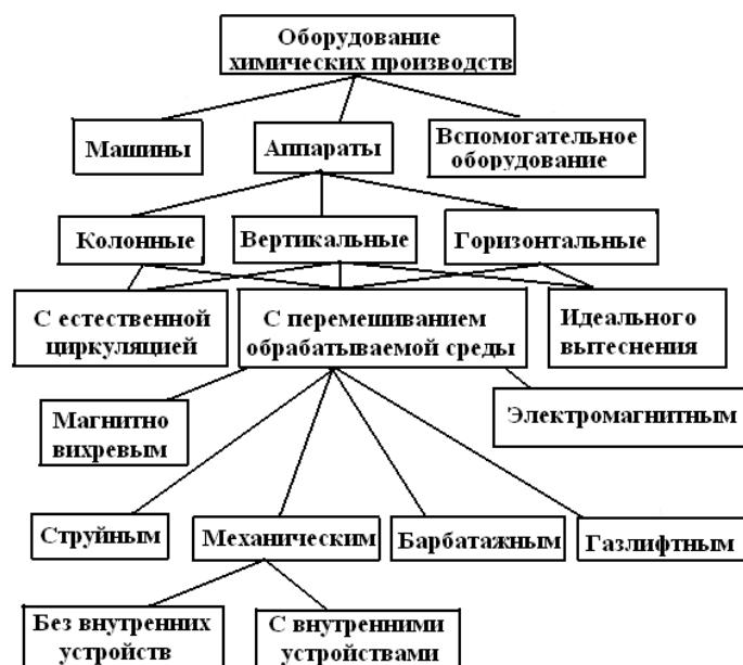
Рисунок 25 - Фрагмент иерархии обобщения оборудования химических производств
