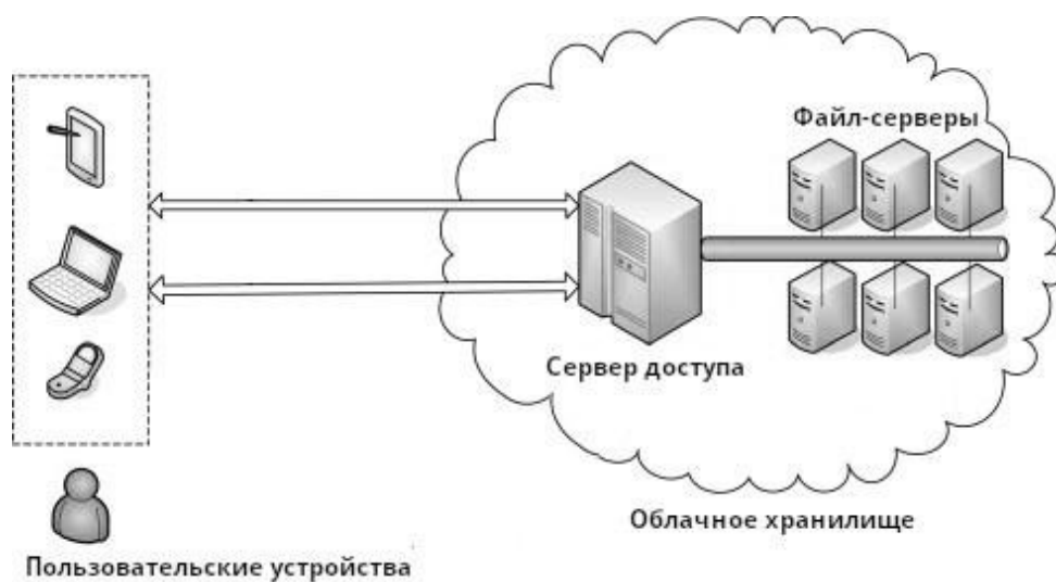
Рис. 69. Пример архитектуры облачного хранилища
