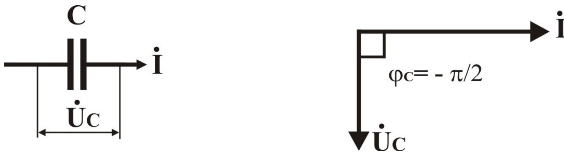
Рисунок 2.3 – Емкость C в цепи переменного тока: изображение на схемах и векторная диаграмма.
