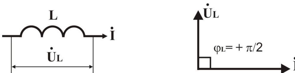
Рисунок 2.2 – Индуктивность L в цепи переменного тока: изображение на схемах и векторная диаграмма.
