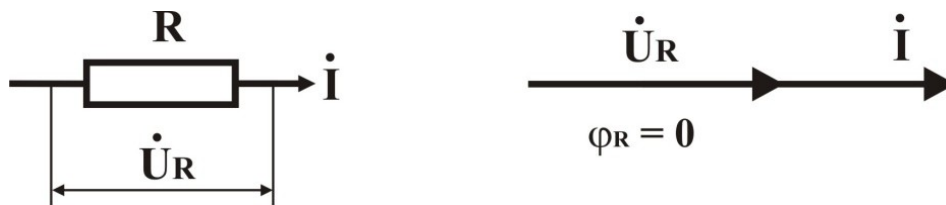
Рисунок 2.1 – Активное сопротивление R в цепи переменного тока: изображение на схемах и векторная диаграмма.
