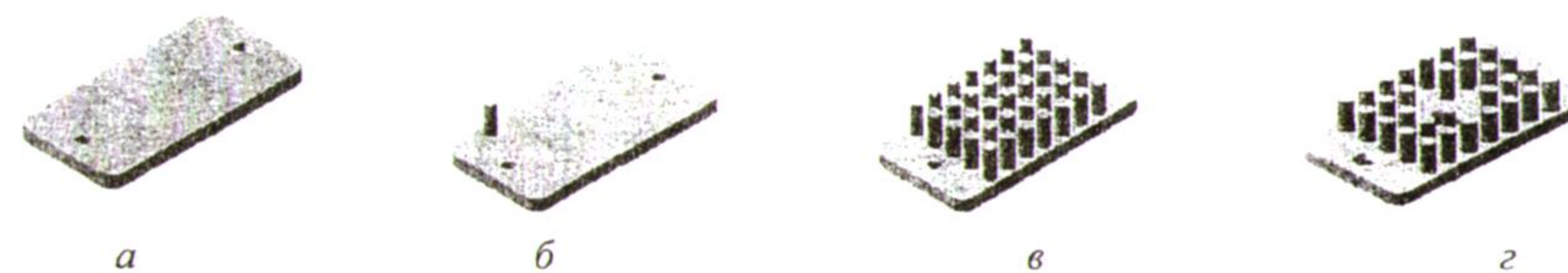
Рис. 1.1. Этапы создания твердотельной модели детали
