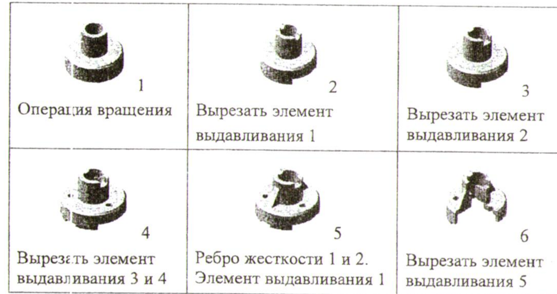
Рис. 3.5. Этапы построения модели кронштейна
