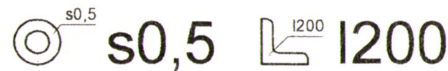
Рис. 2.6. Нанесение размера толщины s и длины l
