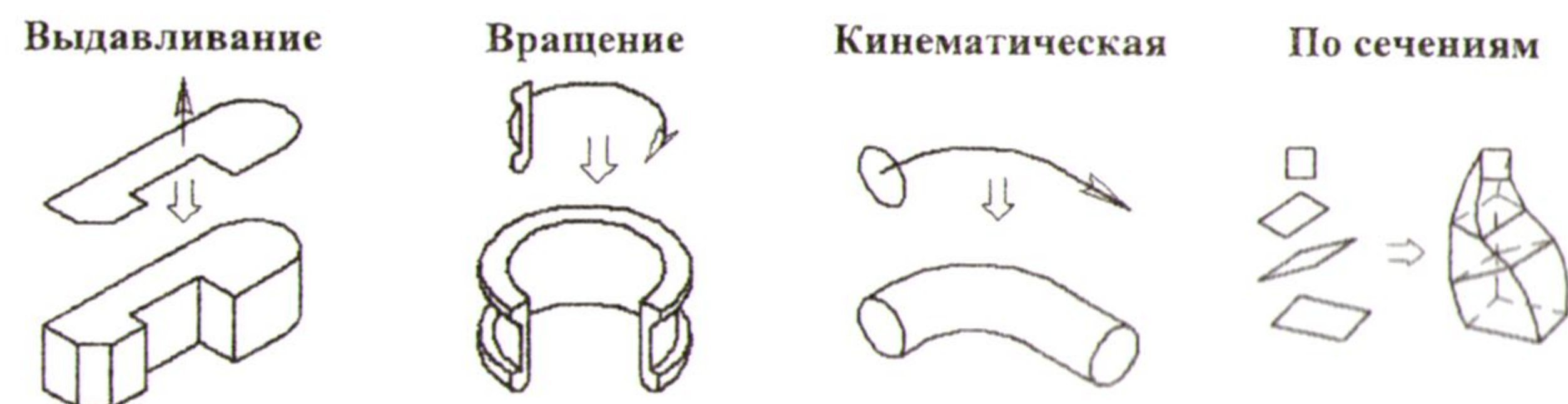
Рис. 1.2. Основные формообразующие операции создания трехмерных объектов
