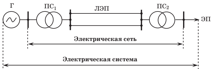
Рис. 1.2. Принципиальная электрическая схема электроэнергетической системы
