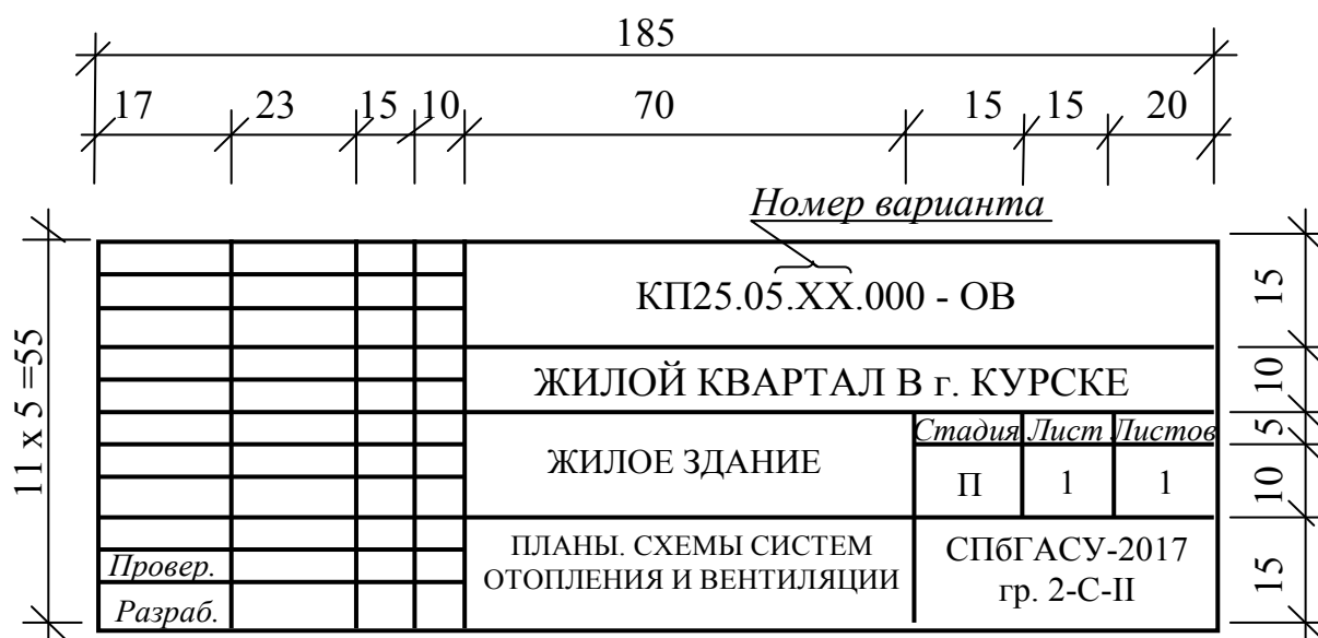
Рис. 10.1. Основная надпись строительных чертежей
