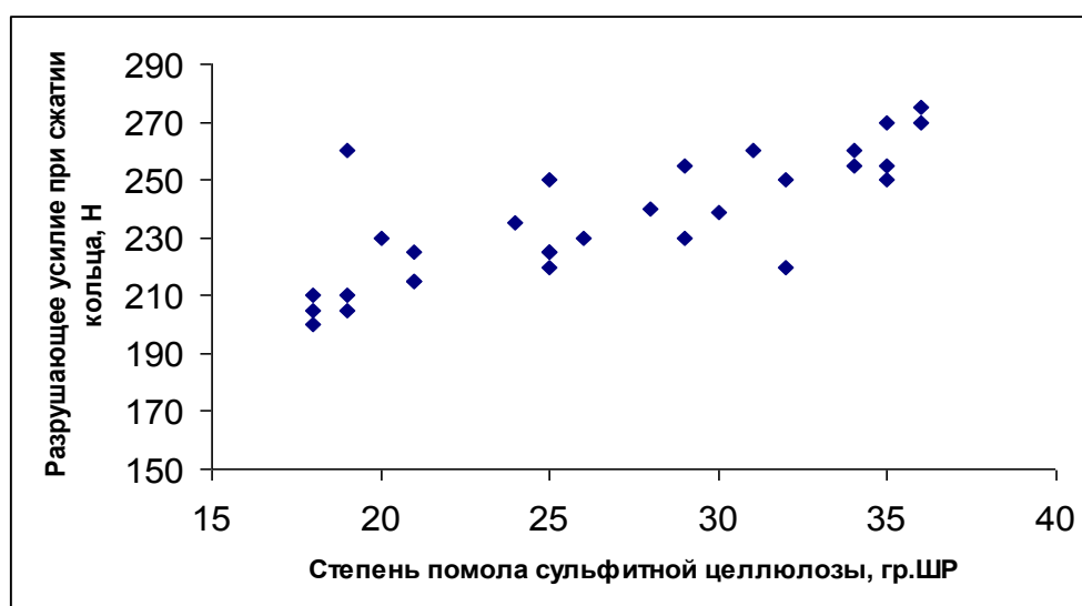
Рис. 15.2. Зависимость разрушающего усилия при сжатии кольца от степени помола сульфитной целлюлозы
