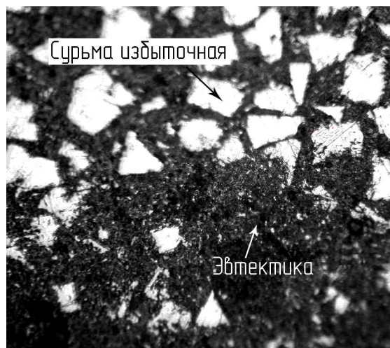
Рис. 10. Сплав Pb-Sb с ликвацией по удельной массе
