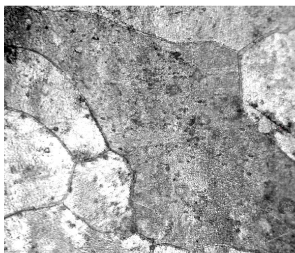
Рис. 13. Сплав Cu-Ni после диффузионного отжига: α-твёрдый раствор
