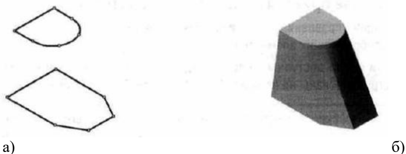
Рисунок 48 – Дуга в верхнем сечении разбита на три сопрягающихся части
