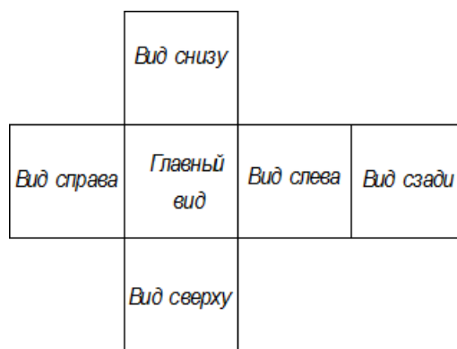
Рисунок 2. Расположение видов детали на чертеже
