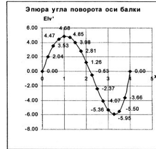
Рис. 6. Эпюра угла поворота оси балки
