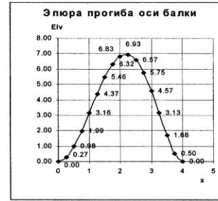
Рис. 5. Эпюра прогиба оси балки
