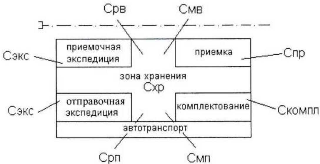
Рисунок 5- Принципиальная схема склада
