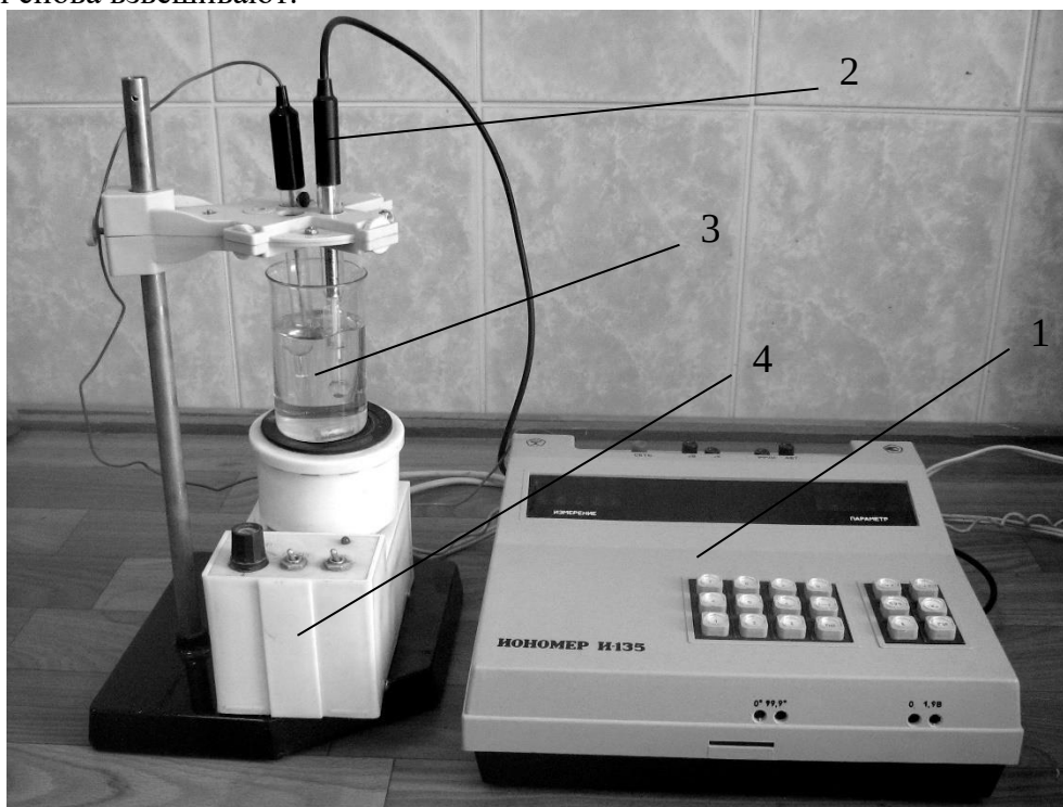
Рисунок - Установка по определению рН среды: 1 – ионометр И-135; 2 – электроды, 3 – стакан, 4 – магнитная мешалка.
