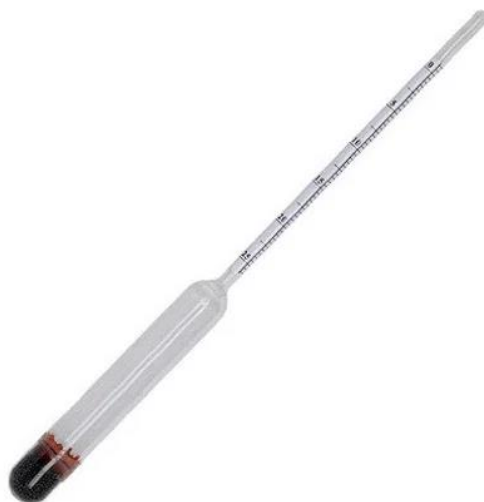
Рисунок 1 – Ареометр для измерения плотности жидкостей
