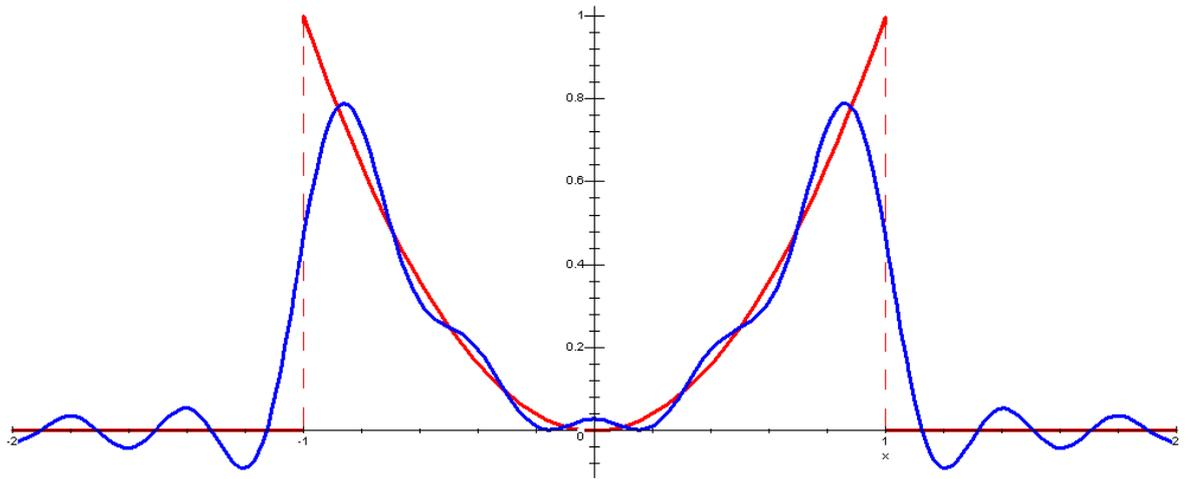
Рис 10. Графики функции  $y = f_3(x)$  — и десятого приближения рядом Фурье —
