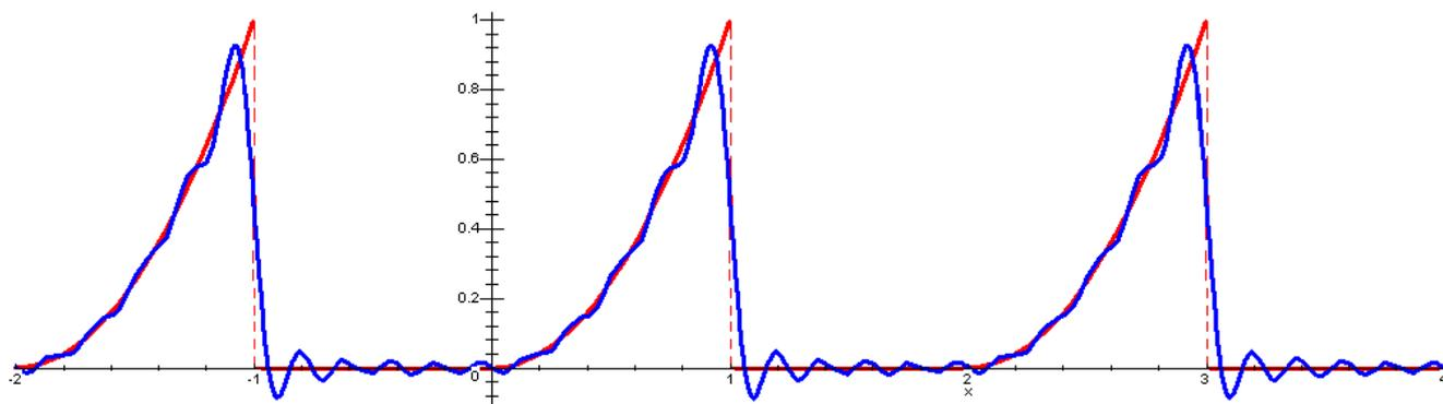
Рис 5. Графики функции  $y = f_1(x)$  — периодического продолжения функции  $y = f(x)$  — и десятого приближения рядом Фурье —
