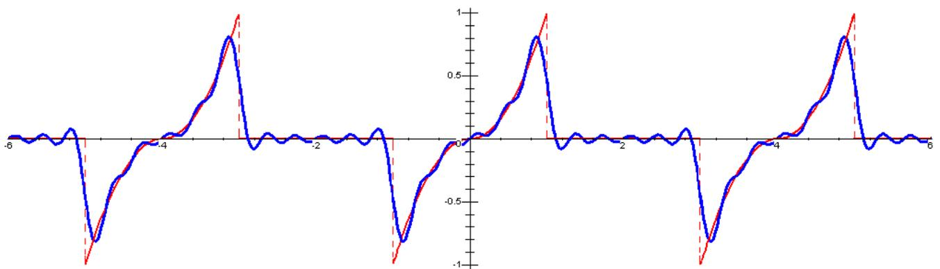
Рис 8. Графики функции  $y = f_2(x)$  — периодического нечетного продолжения функции  $y = f(x)$  — и десятого приближения рядом Фурье —
