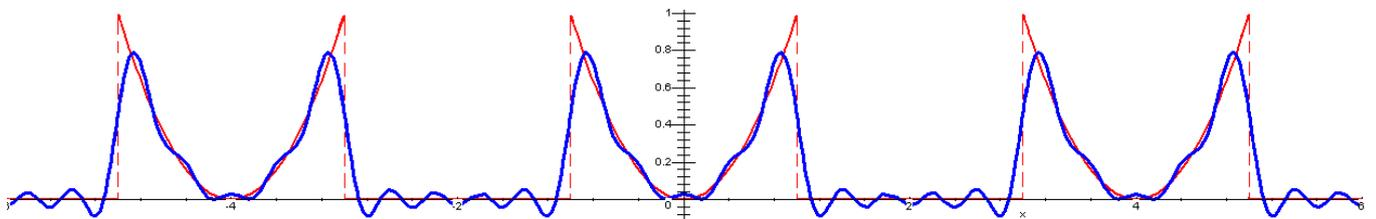
Рис 11. Графики функции  $y = f_3(x)$  — периодического четного продолжения функции  $y = f(x)$  — и десятого приближения рядом Фурье —
