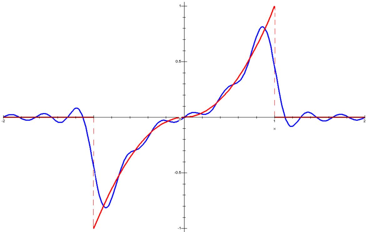
Рис 7. Графики функции  $y = f_2(x)$  — и десятого приближения рядом Фурье —
