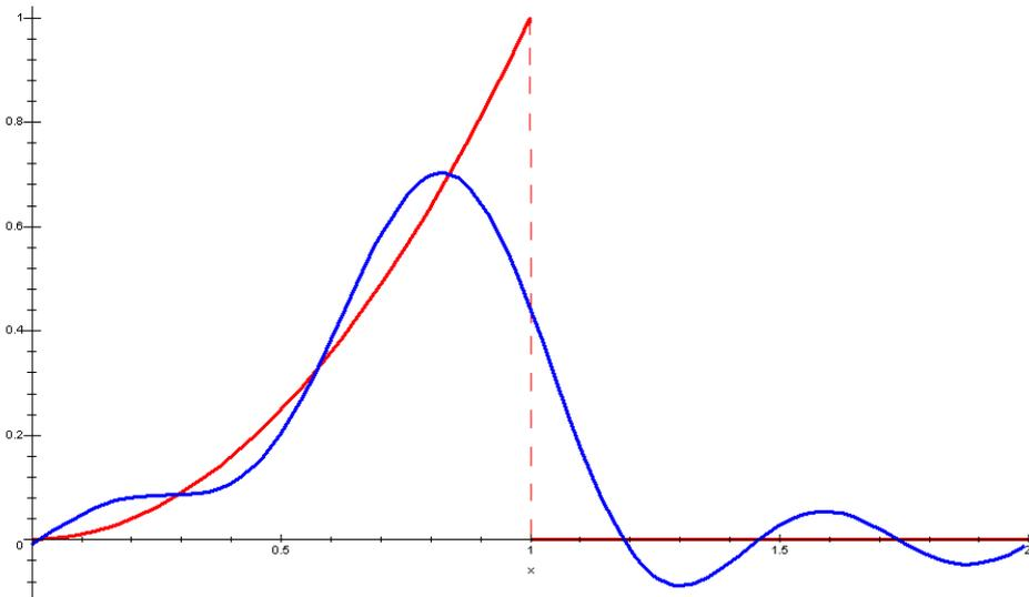
Рис 3. Графики функции  $y = f(x)$  — и третьего приближения рядом Фурье —
