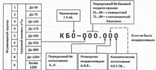
Рисунок 2.1 Система индексации башенных кранов
