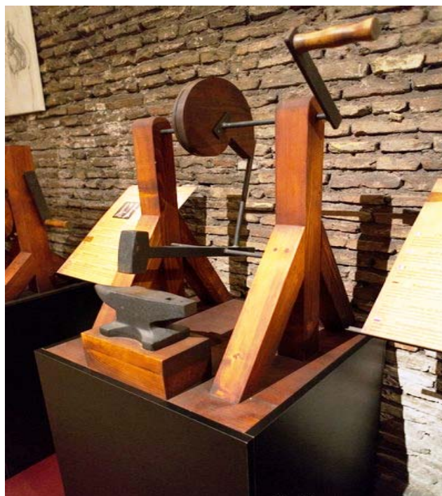
Рис. В.45. Молот, приводимый в движение с помощью кулачка. Музей Леонардо да Винчи в Риме
