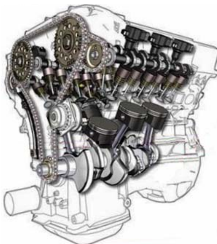
Рис. В.40. V-образная схема расположения цилиндров ДВС, в которой цилиндры и КМ размещаются в ряд с развалом от 10° до 120° в форме латинской буквы «V»
