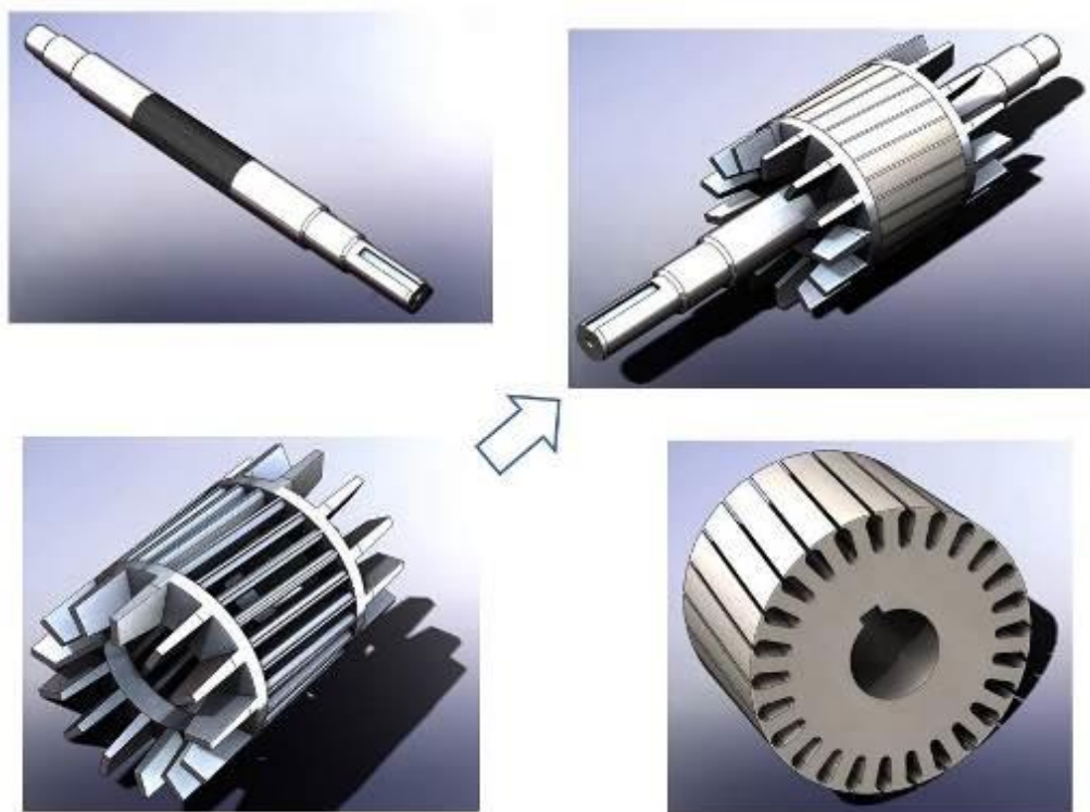
Рис. 0.3 Сборка и компоновка ротора асинхронной машины
