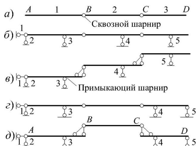
Рис. 1.3. Прикрепление многопролетной балки к основанию
